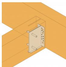
*Assemblage discret sur poutres apparentes*
