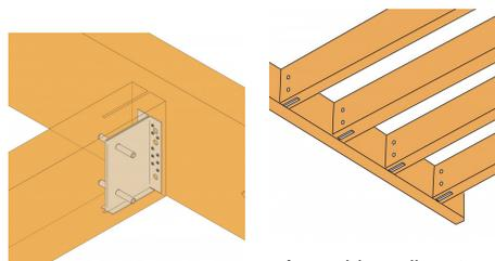
*Assemblage discret sur poutres apparentes*
