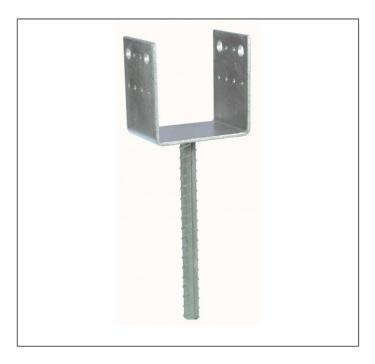
Les pieds de poteau en U à sceller PPD ont été conçus pour faciliter le montage. L'installation dans le béton nécessite des réservations mais permet de régler les niveaux avant de couler le béton.
